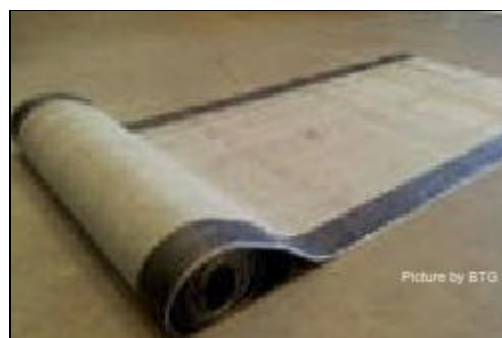
Figur 30: Takpapp med 5% innblanding av bio-olje som erstatning for bitumen (Foto: BTG )
