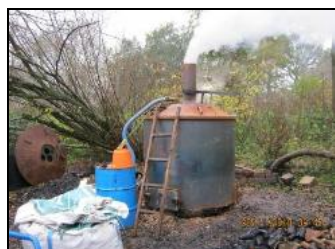
Figur 43: Et enkelt biokull produksjonsanlegg som kan brukes av arbeidsmarkedsbedriften Våler vekst.
