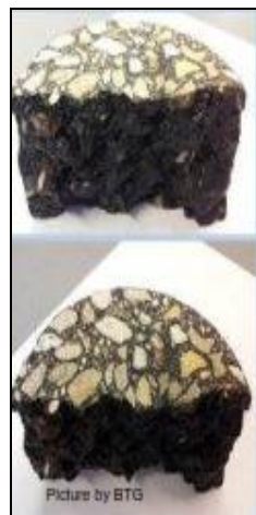
Figur 27. Asfalt med 10% innblanding av bio-olje som erstatning for bitumen (Foto: BTG)
