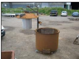
Figur 43: Et enkelt biokull produksjonsanlegg som kan brukes av arbeidsmarkedsbedriften Våler vekst.
