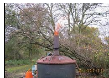
Figur 43: Et enkelt biokull produksjonsanlegg som kan brukes av arbeidsmarkedsbedriften Våler vekst.
