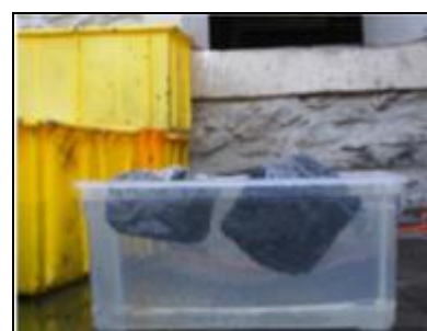
Figur 36. Biokull er et lett materiale og flyter når det plasseres i vann (Foto: Schmidt)
